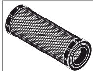
PATRON TIL TØRT LUFTFILTER Reference: 227959 Rengøres: 50 T Udskiftes: 400 T
